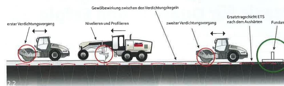
**Ressourcenschonend, für fast alle Materialien geeignet, garantierte Tragfähigkeit, kurze Bauzeit, sehr guter Lastabtrag und wirtschaftlich: Die Grafiken zeigen von links oben nach rechts unten die schrittweise Umsetzung der Hybridgründung „System Terra-Mix“.**
